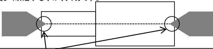
ここに傷や切粉があると軸の中心がずれて同軸度や円筒度の精度が低下してしまいます。
