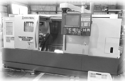
CNC旋盤 SPACE TURN LB3000EX (株)オークマ製
